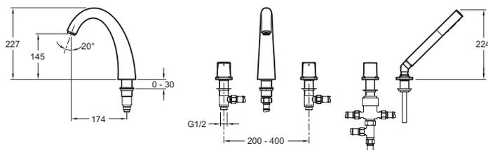
Спецификация продукта : Смеситель для ванны/душа. E18876. Коллекция : ELEVATION. ВЕС : 6.8 кг. МАТЕРИАЛ : N/A. ТИП УСТАНОВКИ : 5 отверстий. DÉBIT (L/MN SOUS 3 BARS) : 25 л/мин. SAILLIE DU BEC (MM) : 174 мм. MÉCANISME : Кран-бухсы с керамическим диском. ENTRAXE (MM) : 200 - 500 мм. GARANTIE FINITION : 10 лет.
